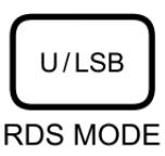
En la banda AM, presione rápidamente para ingresar al modo SSB
