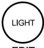
Avec la radio allumée, en mode Mémoire, maintenez appuyé pour renommer une page ; appuyez rapidement pour sélectionner le niveau de brillance du rétroéclairage : high [élévé]-medium [moyen]-low [bas]-off
