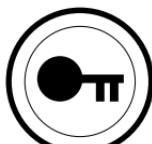
Presione rápidamente para deshabilitar todos los botones y perillas; presione y mantenga para desbloquear todos los botones y perillas
